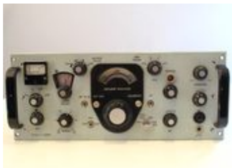
KV přijímač TÁBOR II ze soupravy ANDROMEDA
